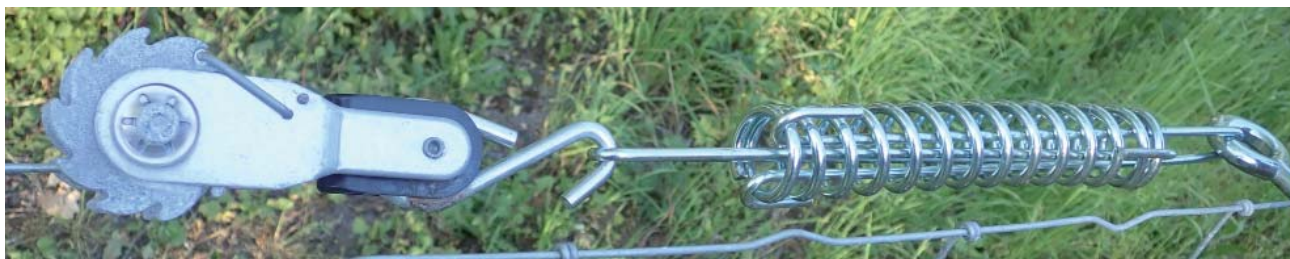
Tendeur rotatif et ressort de fluctuation de tension
