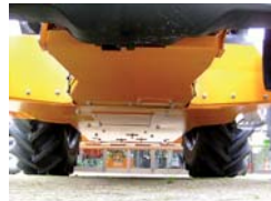
PLAQUE VENTRALE composée de trappes d'entretien et de nettoyage
