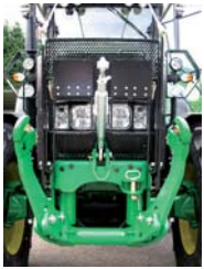
GRILLE FRONTALE protection du capot : radiateur et phares
