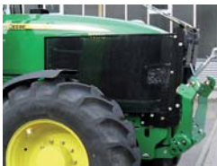
GRILLE LATÉRALE protection du capot et du moteur
