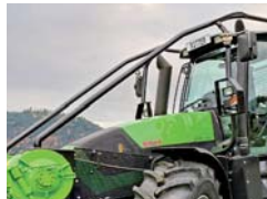
BÂTI PROTECTEUR protection de la cabine défense contre les branches grille de protection frontale intégrée
