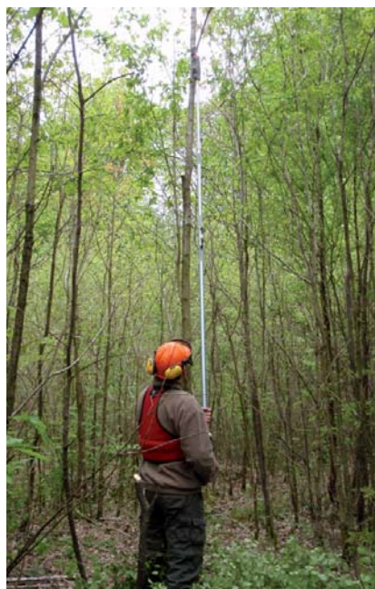
Sécateur et scie électrique ou scie alternative monté sur perche
