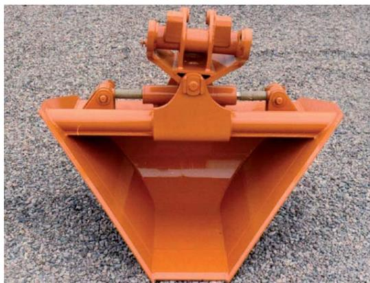
godet à parois orientables permettant de profiler la pente des parois des fossés
