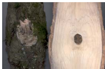
Noeud pourri ( \emptyset altération > 1/3)
