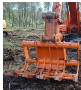
Le nettoyage du terrain à l'aide de tracteur équipé d'un râteau andaineur et surtout d'une lame-Rome peut perturber fortement le sol et décapier la couche de matière organique : ces méthodes sont de plus en plus déconseillées. Au contraire, l'andainage de rémanents opéré par un râteau scarificateur monté sur pelle hydraulique a le double avantage de moins compacter le sol tout en travaillant les couches superficielles du sol
