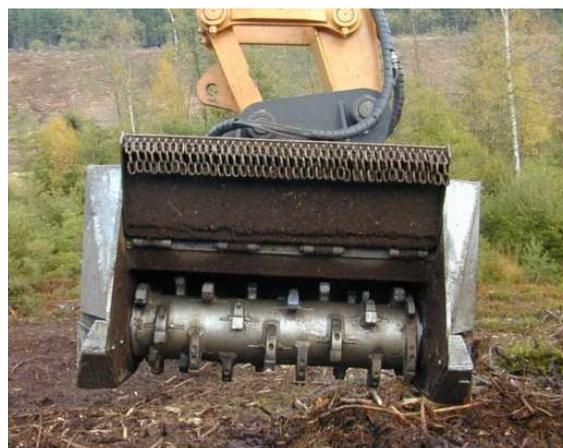
Le gyrobroyeur équipé de dents fixes et monté sur le bras hydraulique d'une grue à chenille est préconisé pour éliminer les rémanents de coupes rases résineuses situées sur sol sensible ou en forte pente
